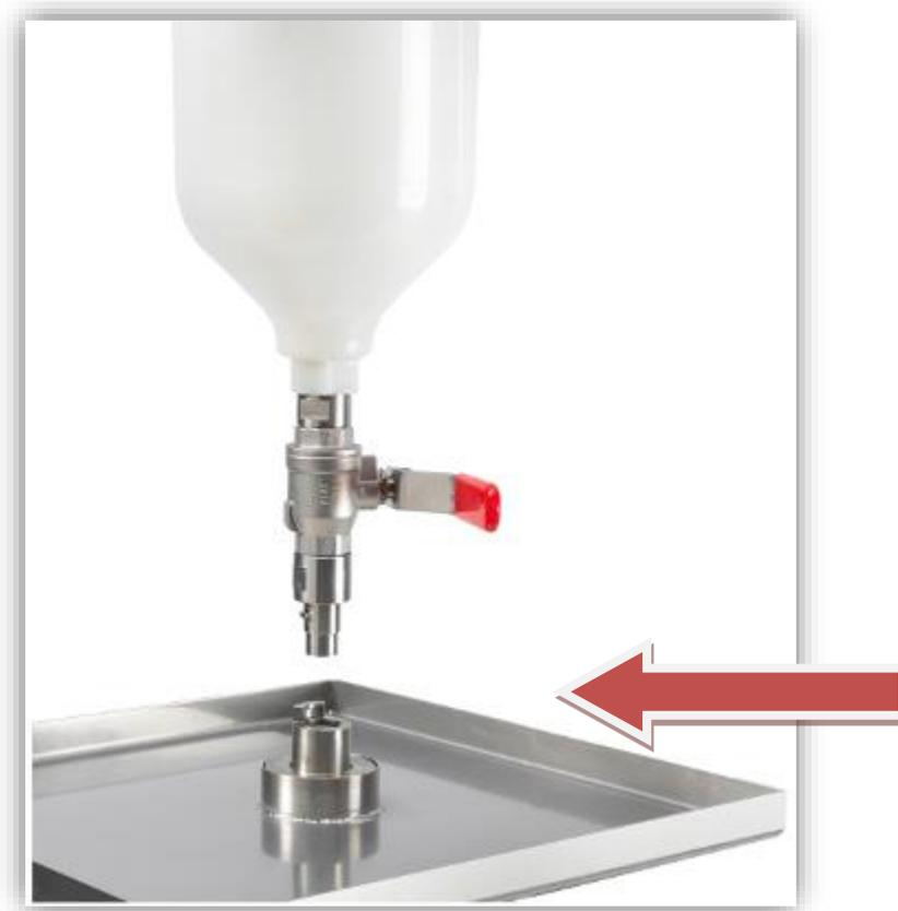
Den 2 Liter Fließbecher mit dem Bajonette-Verschluß (Abb. Nr.3) mit einer halben Drehung auf dem Bajonette-Verschluß-**Unterteil** (Abb. Nr.1+2) festdrehen.
